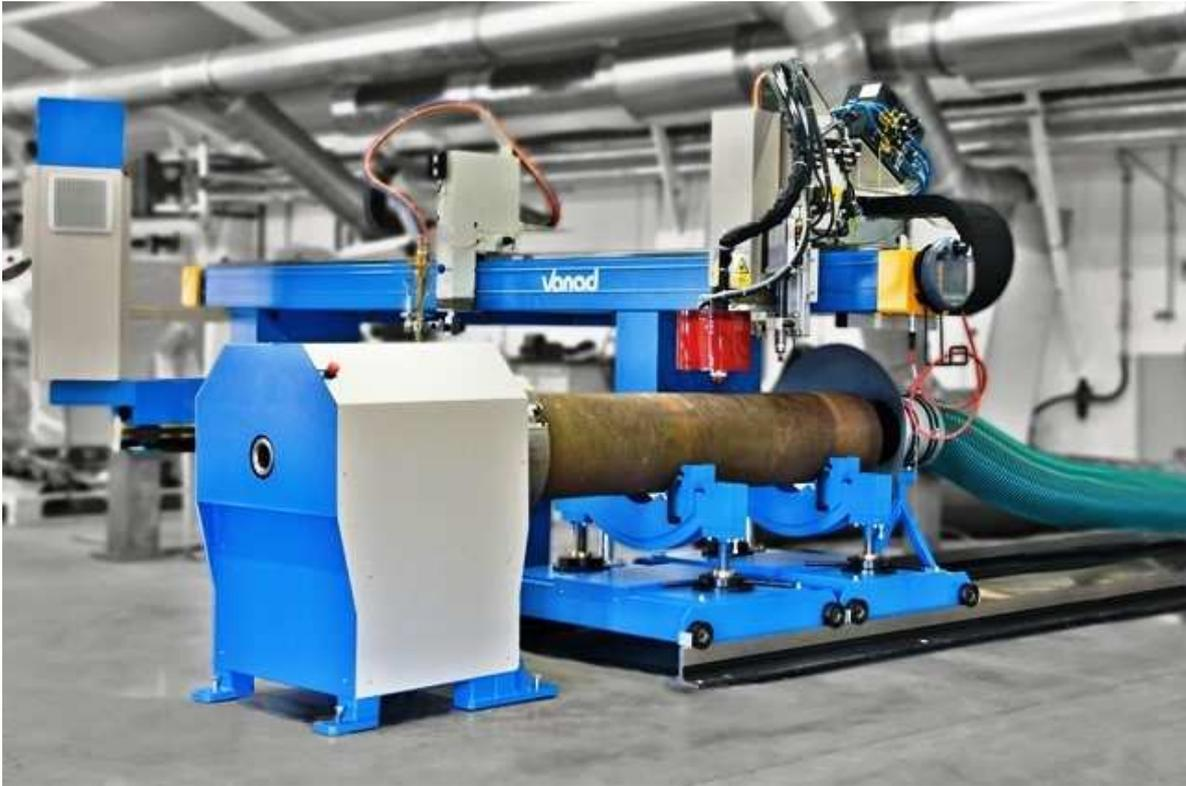
Die **Vanad RotCUT** ist eine moderne, hoch effektive Zusatzanlage zur Bearbeitung von Rohren und Profilen, die zusammen mit Maschinen Vanad geliefert wird. Sie wird zur Fertigung von Komponenten für Stahlkonstruktionen in den unterschiedlichsten Industriebereichen und zum präzisen Schneiden von Formlöchern verwendet. RotCUT zeichnet sich durch eine einzigartige Genauigkeit, Zuverlässigkeit und Leistungsfähigkeit aus. Die Anlage wird den jeweiligen Anforderungen kundenspezifisch angepaßt.
